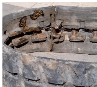
Ärgerlich: Räder und Kettenglieder sind durch lange Standzeit eingeroset Bild: Archiv
