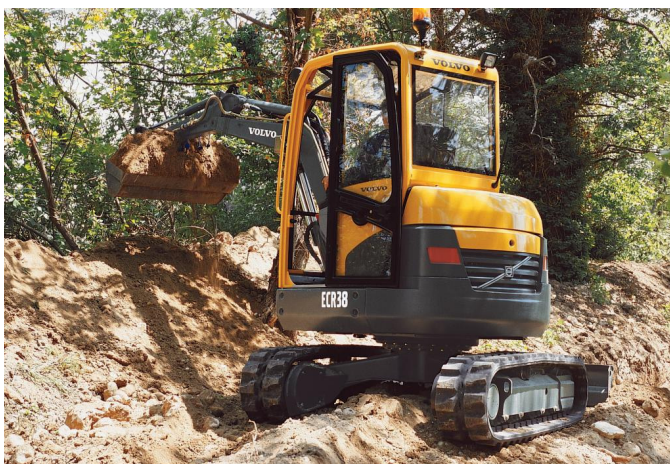
Die meisten kompakten Baumaschinen fahren und arbeiten auf Gummiketten
