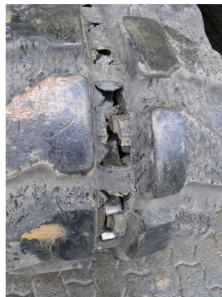
Typisches Schadensbild einer Kette, die auf einem verschlissenen Turas „kaputtgeritten“ wurde
