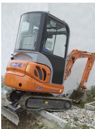
Vorsicht Falle: Kantenüberfahrten können zu schweren Knickschäden im Innenleben der Gummikette führen Bild: Archiv
