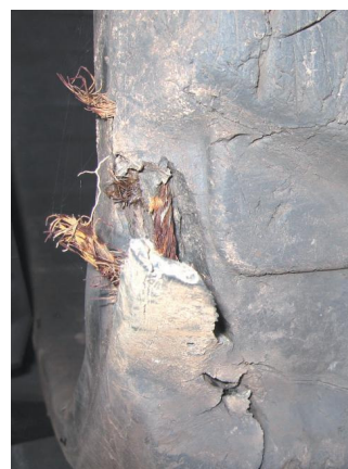
Vorsicht Falle: Kantenüberfahrten können zu schweren Knickschäden im Innenleben der Gummikette führen Bild: Archiv
