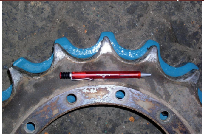
Der Zustand des Turas ist entscheidend für die Lebenserwartung der Gummikette Bild: TAGEX Technischer Handel
